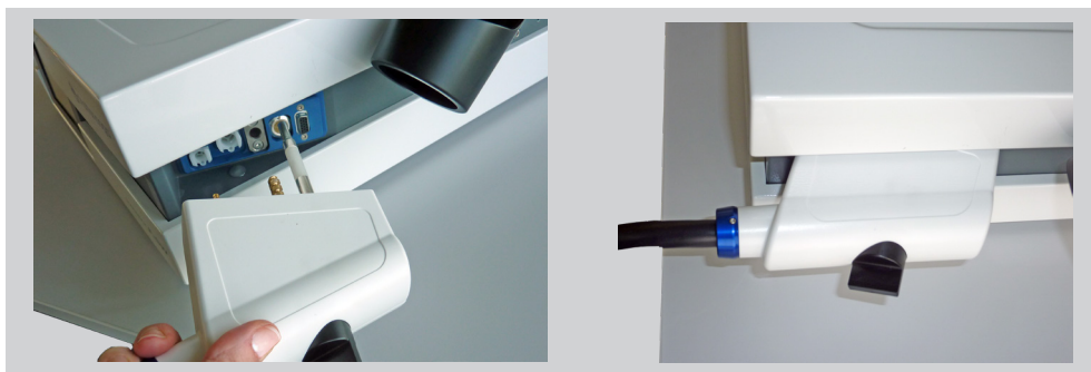
Afb. 4-10 Aansluiting van het F-SW-handstuk
