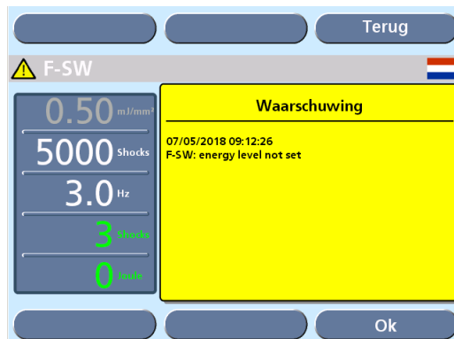
Afb. 5-19 Foutmelding: Energie niveau niet ingesteld
